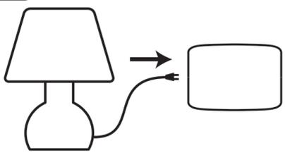
1. Enchufe el dispositivo de iluminación que desea controlar al tomacorriente controlado por Z-Wave del interruptor inteligente, tal como se indica en el logotipo de Z-Wave.
