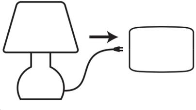
1. Branchez l'appareil d'éclairage que vous voulez commander sur la prise commandée Z-Wave identifiée par le logo Z-Wave, sur le côté de l'interrupteur intelligent.
