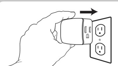
2. Enchufe el reductor de luz inteligente directamente en un tomacorriente con conexión a tierra (si es posible, se recomienda el tomacorriente superior).
